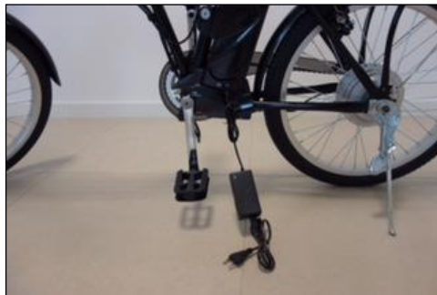
Figura 15 – Cavo del carica batterie collegato alla batteria d'alimentazione della bicicletta.
